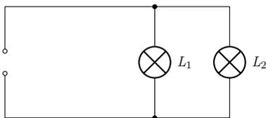
Die Spannung an der Quelle soll sich, genauso wie die Widerstände an den Lampen, jeweils über einen Schieberegler einstellen lassen. Für alle drei Bauteile ist die Spannung und Stromstärke in einem Text in der Zeichnung anzugeben. Dabei gilt: Die Lampen haben immer die gleiche Spannung wie die Quelle. Die Stromstärke an den Lampen berechnet sich aus:
