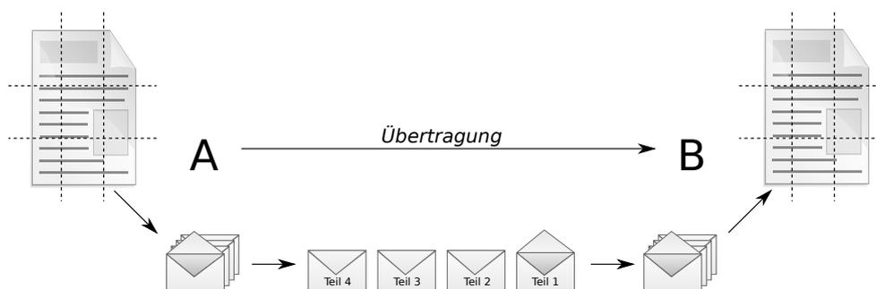
Abbildung 1: Schematische Übertragung einer Papierseite mittels mehrerer Briefe
