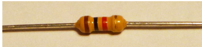
Abbildung 1: Ein Widerstand mit 1\text{ k}\Omega
