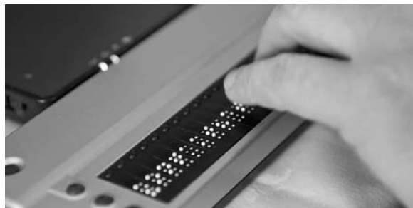
Abbildung A.03: Für Blinde können die Texte eines Computers bei der Ausgabe in Braille-Schriftzeichen codiert und ausgegeben werden.
